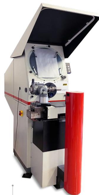
*Il proiettore dei profili al microscopio per la verifica delle imperfezioni più impercettibili è il passaggio più recente della continua evoluzione Montenero*
